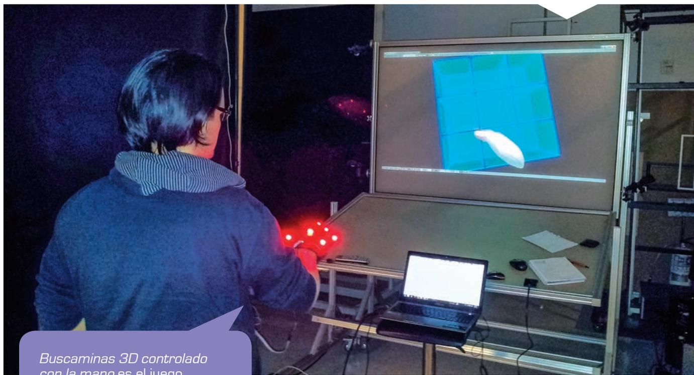
*Buscaminas 3D controlado con la mano* es el juego interactivo diseñado por Nicolás Mendoza. Los controles usados se basan en gestos predefinidos hechos con la mano del usuario y para capturar esos movimientos mediante un guante se usa el sistema "PhaseSpace".
